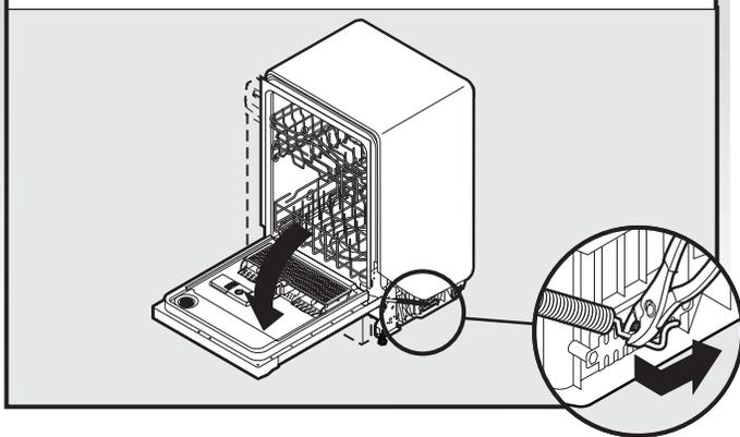
Si la porte s'ouvre sous l'effet de son propre poids, augmenter la tension des ressorts : déplacer le point d'ancrage de chaque ressort vers l'arrière du lave-vaisselle.
